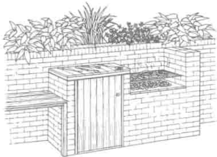
استفاده از آجر برای ساخت کباب پز و لیگت
